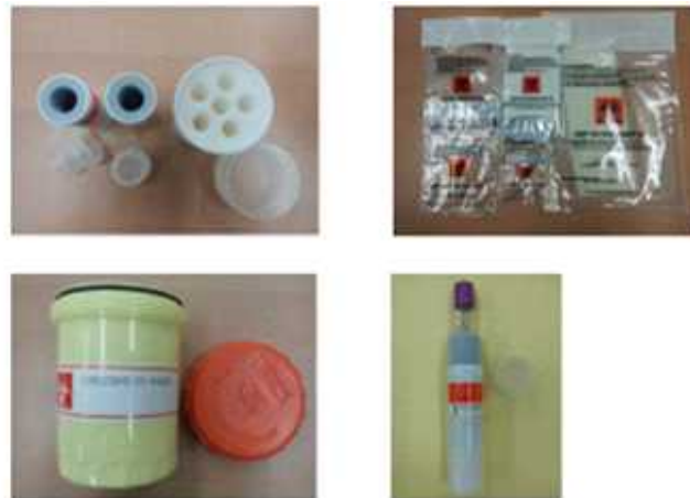
그림 5. 카테고리 B 2차 포장용기 예. 출처: 질병관리본부, 감염성물질안전수송지침 2013.
